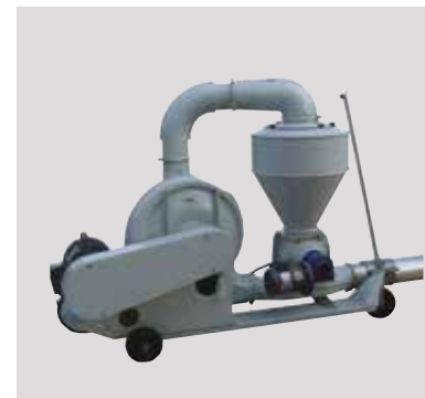
พัดลมดูดเคลื่อนที่ ใช้สำหรับการลำเลียงระหว่างจุดต่างๆ
