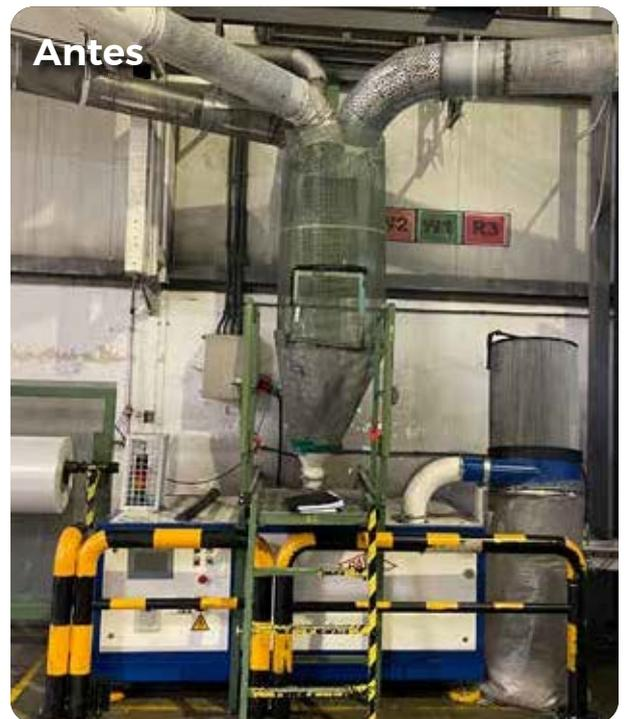
**Antes** de instalar el sistema, la tira continua a veces no se descargaba correctamente en la compactadora y, como consecuencia, se provocaban atascos en los rodillos.
