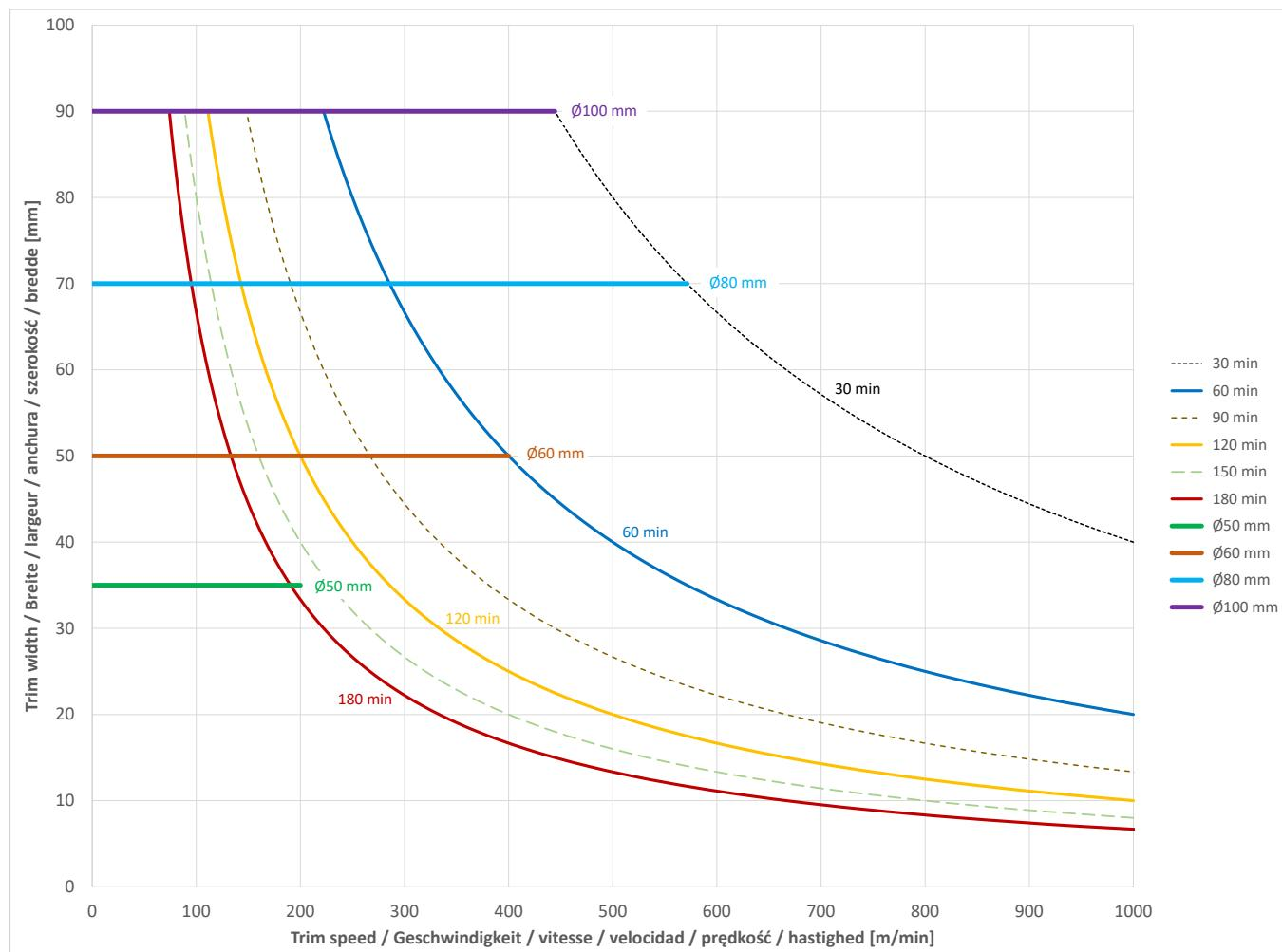
**Bag filling time at 2 strips / Beutelfüllzeit bei 2 Streifen / Temps de remplissage du sac à 2 bande / Tiempo de llenado de la bolsa a 2 tira / Czas napełniania worka przy 2 taśmie / Pose fyldningstid ved 2 strimler.**
