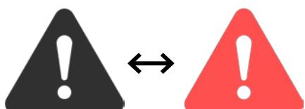
Si un défaut se produit dans le convertisseur de fréquence, l'icône située dans le coin supérieur gauche clignote, passant du noir au rouge. Les messages d'erreur sont directement envoyés depuis la commande du convertisseur de fréquence au tableau de commande.
