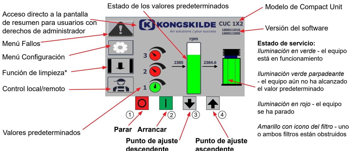
\*: Función de limpieza que cierra la compuerta de la válvula para mantener una aspiración constante hasta el tubo del compactador. Mientras el botón esté pulsado, la trampilla permanece cerrada. Esto puede eliminar un tapón de material que se haya acumulado en la tubería de material por encima del pistón. La alimentación de material al equipo debe detenerse antes de utilizar esta función.
