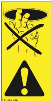
Nigdy nie wkładać rąk do wylotu działającego urządzenia do przetwarzania ścinków.
