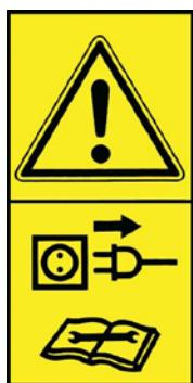
Débranchez systématiquement le système avant de procéder à des travaux de réparation et de maintenance et assurez-vous qu'il ne peut pas être démarré par inadvertance.
