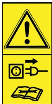
Przed przystąpieniem do naprawy lub konserwacji zawsze odłączać zasilanie urządzenia do przetwarzania ścinków i zabezpieczać przed przypadkowym uruchomieniem.
