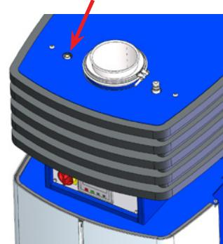
5. Apriete el prensaestopas en la parte superior del Compact Unit. Si se desea, el cable puede aliviarse aún más con una brida para cables en la guía en T situada encima del bloque de terminales.
