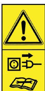
Afbryd altid strømmen til kompaktoren før reparation og vedligeholdelse og sørge for at den ikke kan startes ved en fejltagelse.
