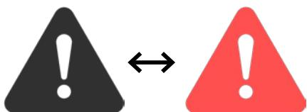
Hvis der opstår en fejl i omformeren, blinker ikonet i øverste venstre hjørne mellem sort og rødt. Fejlbeskederne bliver sendt fra frekvensomformerens styring direkte til operatørpanelet.
