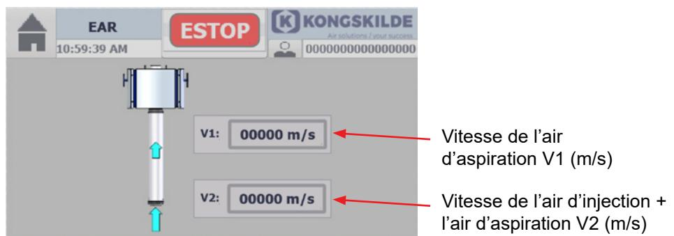
Vitesse de l'air d'aspiration V1 et Vitesse d'enlèvement V2 (air d'injection + air d'aspiration) peut être lu dans ce menu, mais uniquement corrigé sous Sélection des composants (voir section « Sélection des composants »).
