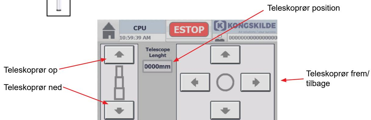
På piltasterne kan teleskoprøret køres hhv. op og ned samt frem og tilbage. Yderligere kan røret hæves, f.eks. i tilfælde af at tömningsprocessen er blevet afbrudt, eller under indstilling af Telescope setpoint setting.
