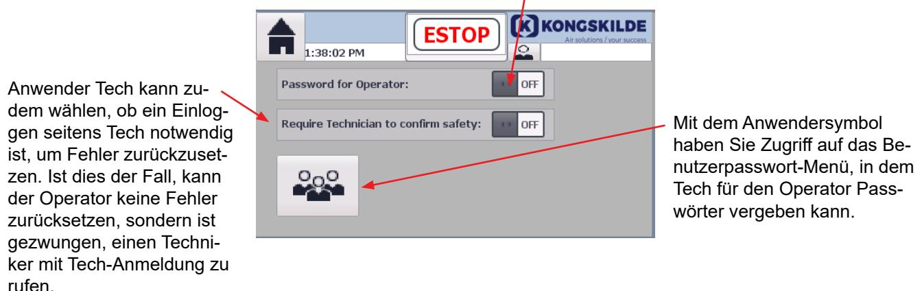
Im Menü für Benutzerpasswörter kann Tech Passwörter für den Operator vergeben und ändern, und zudem das Passwort für Tech ändern:
