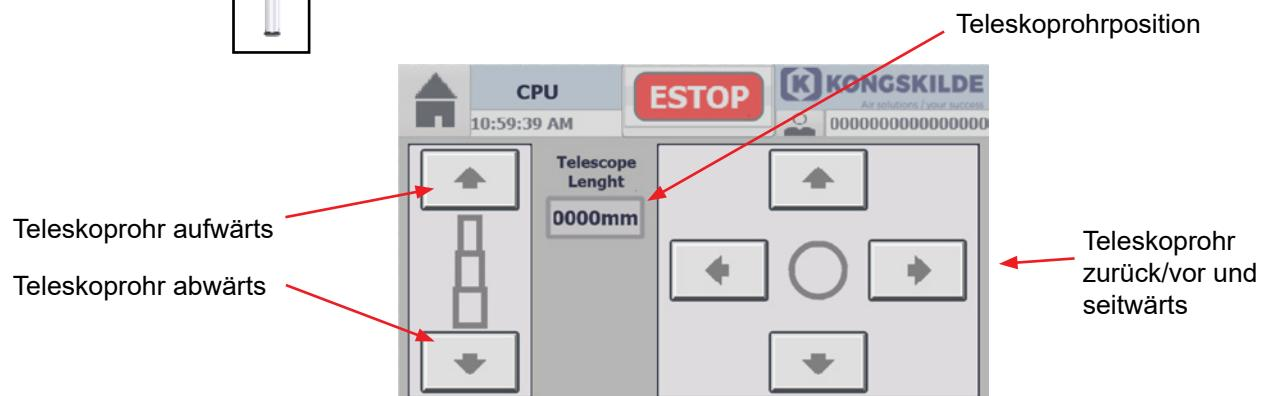
Mit den Pfeiltasten kann das Teleskoprohr nach oben und unten sowie zurück und vorwärts bewegt werden. Darüber hinaus kann das Rohr angehoben werden, z. B. wenn der Entleerungsvorgang unterbrochen wurde oder während der Einstellung des Teleskop-Sollwerts.
