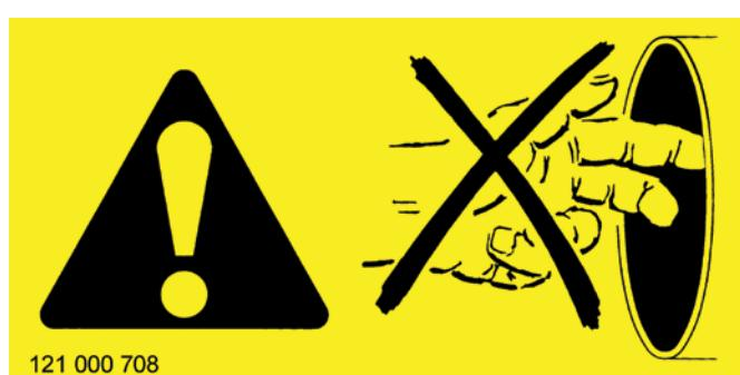
Nigdy nie należy wkładać ręki do wlotu lub wylotu urządzenia CVL podczas jego pracy. Ryzyko obrażeń!
