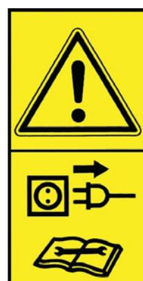
Los conductos no deben desconectarse mientras la unidad CVL se encuentre en funcionamiento. Espere a que se hayan el aire comprimido y la alimentación eléctrica.
