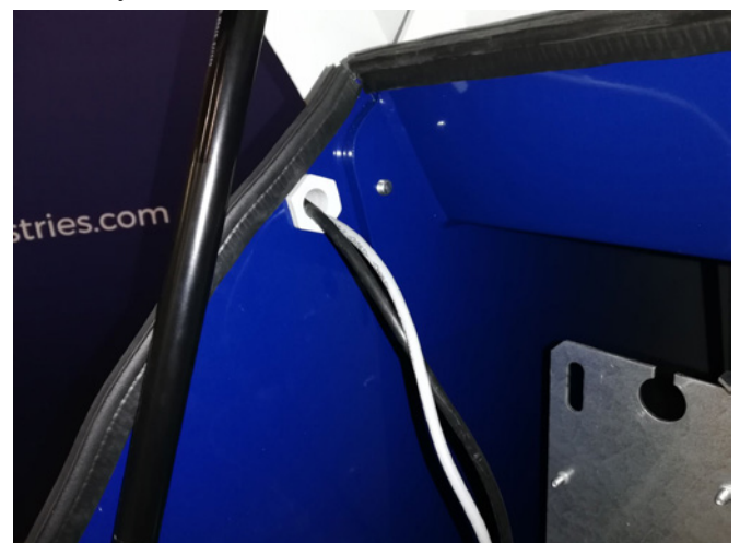
8 - Manöverpanelens ledningar dras genom skåran i ändplattan och avlastningen säkras. 24V DC-kablarna och datakabeln återansluts och säkras med buntband. Dörrarna stängs och strömmen kopplas in igen med huvudbrytaren.
