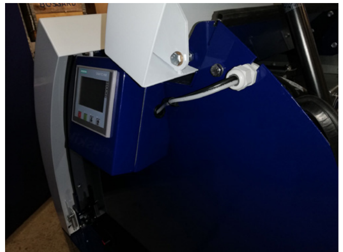
8 - Manöverpanelens ledningar dras genom skåran i ändplattan och avlastningen säkras. 24V DC-kablarna och datakabeln återansluts och säkras med buntband. Dörrarna stängs och strömmen kopplas in igen med huvudbrytaren.
