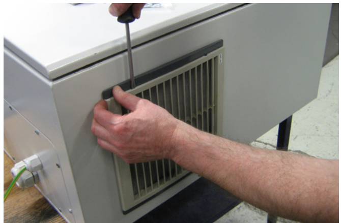
1 - Presser les deux clips pour dégager le cadre en plastique.
