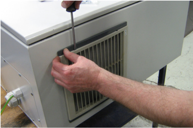
1 - presione ambos clips para liberar la rejilla de plástico.
