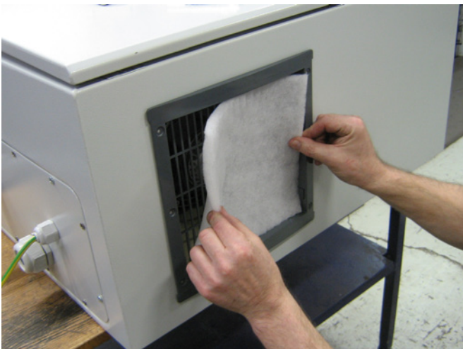
3 - Entfernen sie den Filter und reinigen sie ihn, wenn nötig. Der Wiedereinbau erfolgt in umgekehrter Reihenfolge.
