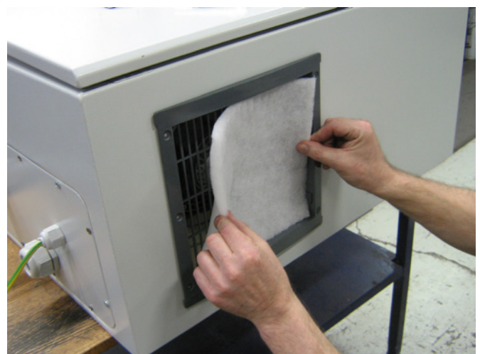
3 - fjern filtret, og rens det om nødvendigt. Genmontage er i modsat rækkefølge.
