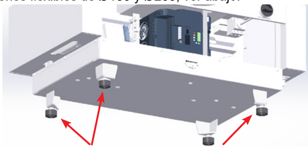
Atenuadores de vibración
