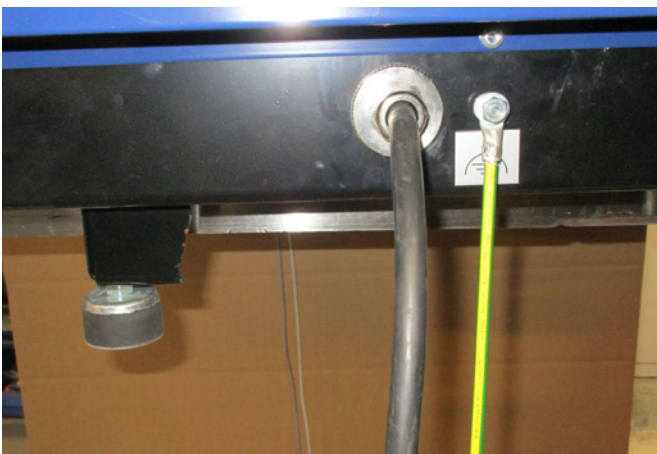
2 - Il cavo di potenza è posto attraverso il pressacavo sulla base del ventilatore lato destro (visto dal lato motore). Il cavo di terra è installato e fissato alla destra del cavo di potenza.
