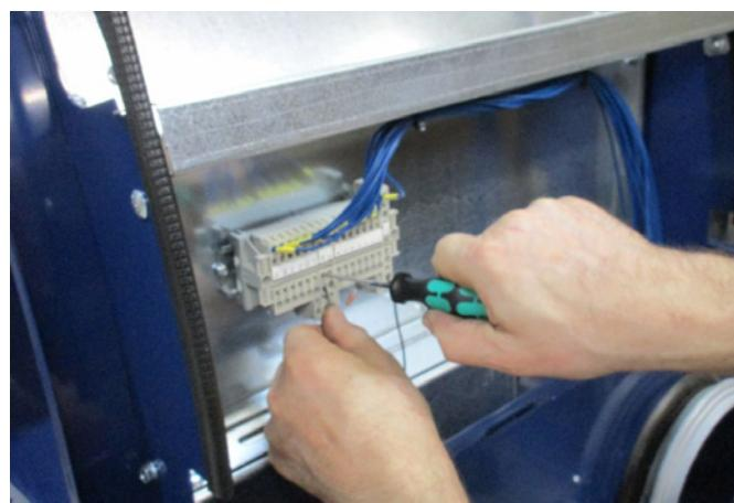
4 - Zacisnąć odprężacz kabla i ponownie zamontować pokrywę dmuchawy.
