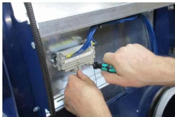
4 - Die Kabelentlastung wird angezogen, und die Gebläse-Abdeckung wieder angebracht.
