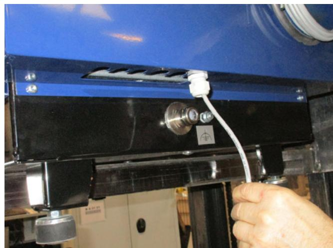
4 - Kabelförskruvningen spänns och flätkåpan återmonteras.
