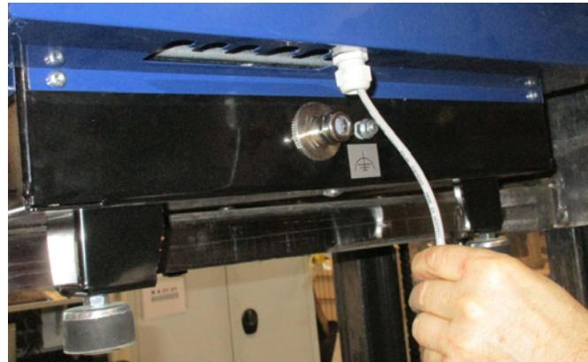
3 – Die Klemmen werden mit Hilfe eines kleinen Schraubenziehers geöffnet, und die Kabel gemäß folgendem Schema installiert:
