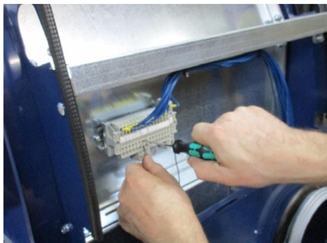
4 - Apriete el pasacables y vuelva a montar la tapa lateral del ventilador.
