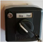
Zewnętrzny włącznik START/STOP jest podłączony w listwie zaciskowej X30 pomiędzy terminalem 1 (+24 VDC) a 3 (cyfrowe wejście 0), oraz pomiędzy terminalem 1 i 4 jest wpięta zworka.
