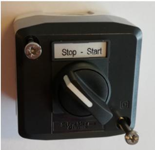
Den eksterne start/stop kontakt tilsluttes i terminalklemme X30 mellem klemme 1 (+24VDC) og 3 (Digital Input 0), og der monteres en lus mellem klemme 1 og 4.
