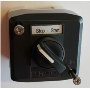
Der externe Start/Stopp-Kontakt wird auf Klemmleiste X30 zwischen den Klemmen 1 (+24VDC) und 3 (Digitaleingang 0) angeschlossen. Zwischen den Klemmen 1 und 4 wird eine Schleife installiert.
