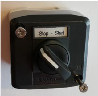
Den externa start / stoppkopplaren är ansluten i terminalblock X30 mellan terminal 1 (+ 24 VDC) och 3 (Digital Ingång 0), och en slinga är dragen mellan terminalerna 1 och 4.
