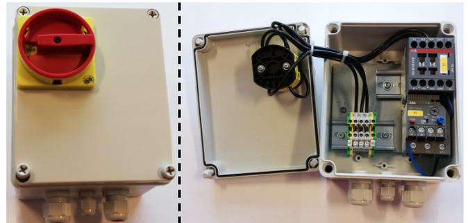
Den eksterne motorstyring tilsluttes i terminalklemme X30 mellem klemme 2 (0 VDC) og 16 (Digital Output 3), og der monteres en lus mellem klemme 1 (+24 VDC) og 12.
