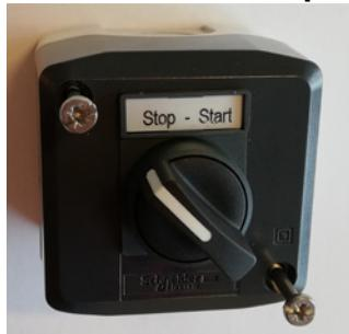
El interruptor remoto de marcha/paro se conecta al terminal X30 entre el terminal 1 (+24 VDC) y el terminal 3 (entrada digital 0), y realizar un puente entre los terminales 1 y 4.
