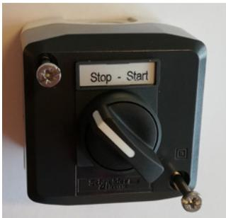
Der externe Start/Stopp-Kontakt wird auf Klemmleiste X30 zwischen den Klemmen 1 (+24VDC) und 3 (Digitaleingang 0) angeschlossen. Zwischen den Klemmen 1 und 4 wird eine Schleife installiert.
