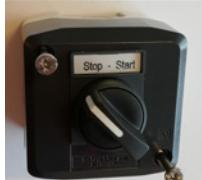
L'interrupteur externe Marche / Arrêt est connecté au bornier X30 entre le terminal 1 (+ 24 VDC) et le terminal 3 (entrée numérique 0) et une boucle est installée entre le terminal 1 et le terminal 4.
