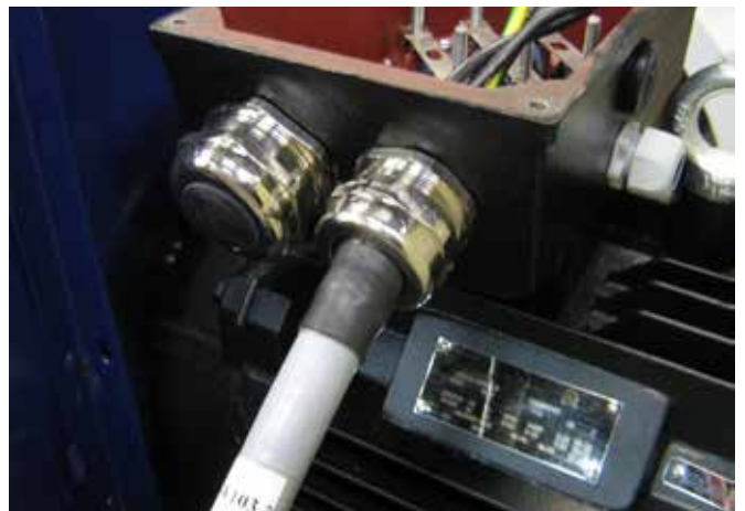
7 - Vergewissern sie sich, dass das Kabel wie dargestellt platziert wird.
