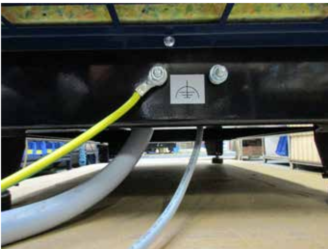
11 - Montieren sie das Potentialausgleichskabel, und ziehen sie die Mutter sicher an (die rechte Klemme ist für die Erdung zum Aufstellungsuntergrund).
