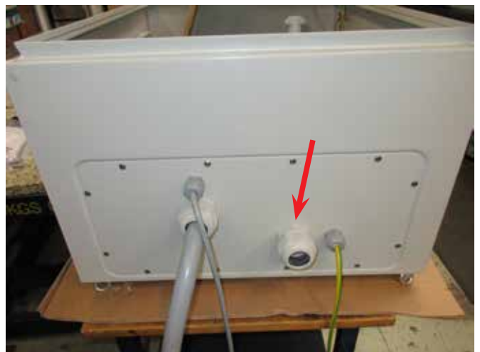
14 - Le câble de puissance de l'armoire de contrôle est passé au travers du presse étoupe comme indiqué.
