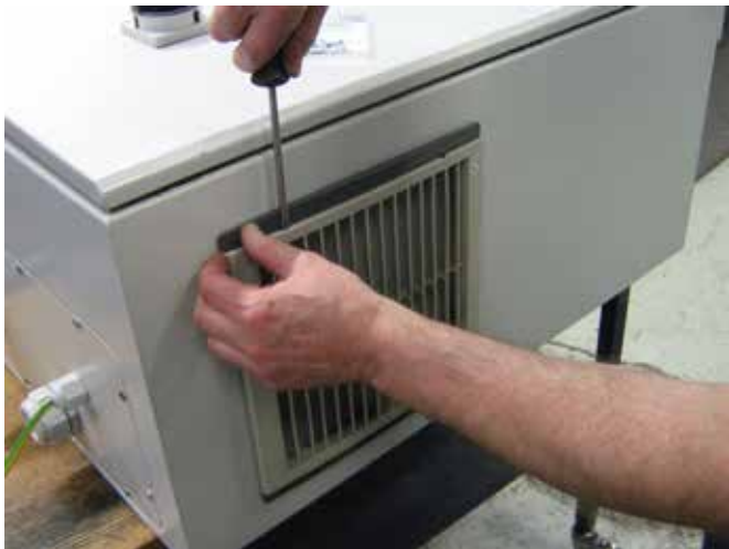
1 - presione ambos clips para liberar la rejilla de plástico.
