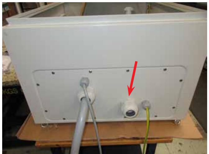
14 - Die Stromversorgung zum Schaltkasten wird wie angezeigt durch die Kabelentlastung geführt.
