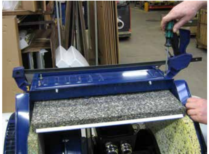
12 - Remontieren sie die obere Platte mit den 4 Schrauben. Eventuell müssen die Seitenwände leicht gedrückt werden, um die Schraublöcher auszurichten.
