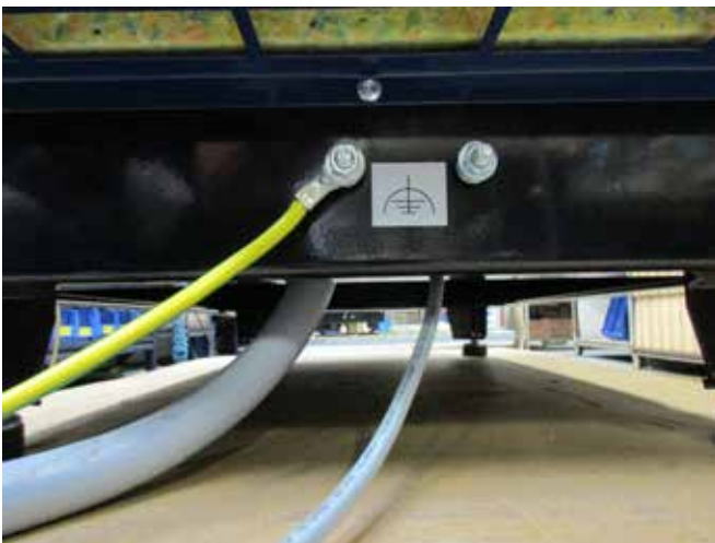
11 - Installer la masse et resserrer l'écrou correctement (borne de droite pour la terre en usine).
