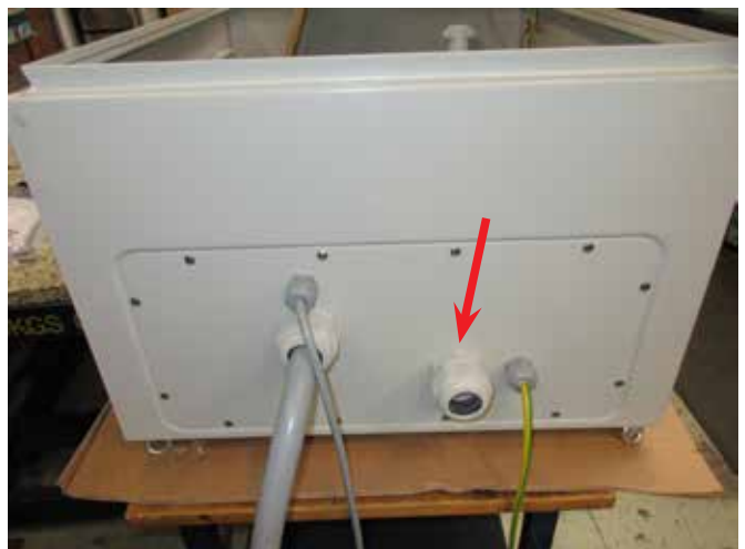
14 - strømforsyningskablet til styreboksen føres gennem forskruingen som vist ovenfor.
