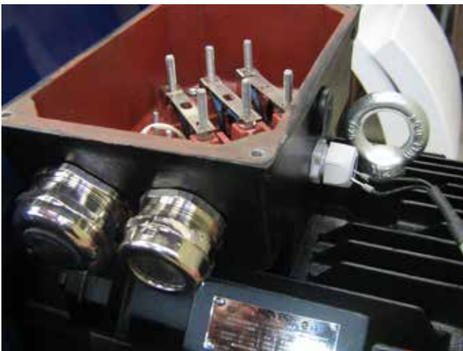
4 - låget på motortilslutningsboksen fjernes, og termistorkablet føres gennem forskrutningen som vist.
