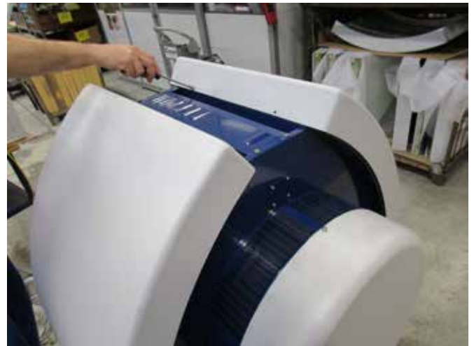
1 - Déposer le couvercle sur les 2 côtés du ventilateur.
