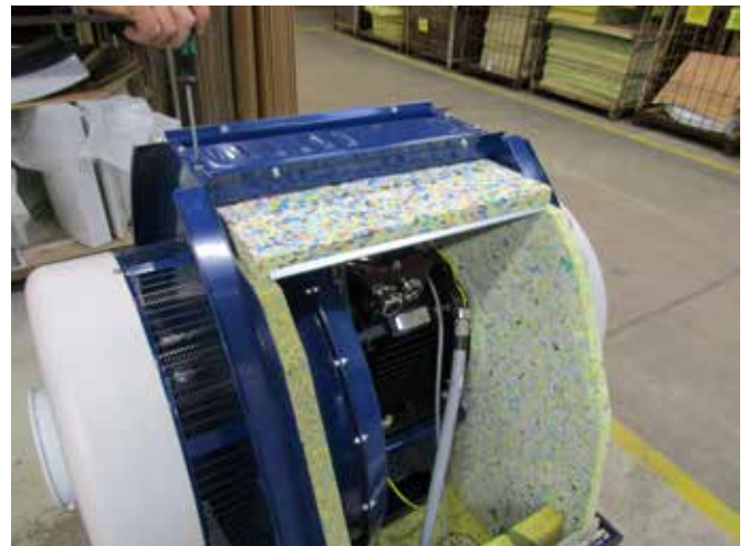
2 - Retirer les 4 vis fixant le panneau supérieur et le déposer à côté. Pousser le panneau vers le bas pour le dégager de ses encoches.
