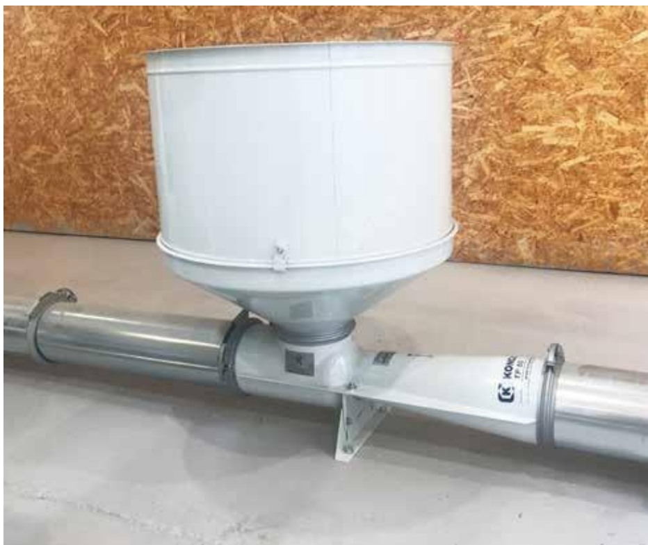
Injektor z koszem rozładunkowym i zamontowanym przedłużeniem kosza
