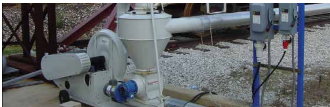
Dmuchała odciągowa SUC 200 E służy do opróżniania masowych wagonów kolejowych z granulki i przenoszenia granulki do silosów magazynowych.
