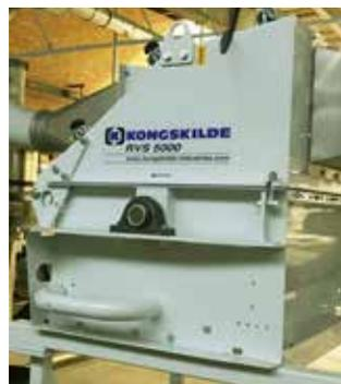
Le séparateur RVS H sépare les matériaux légers du flux d'air de la tuyauterie d'aspiration. La connexion de tuyauterie permet de maintenir la zone des paliers exempte de poussière.
