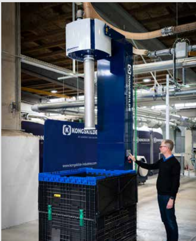
Gotowe elementy są przenoszone z miejsca składowania do hali produkcyjnej lub obszarów pakowania za pomocą jednostki do podnoszenia elementów
