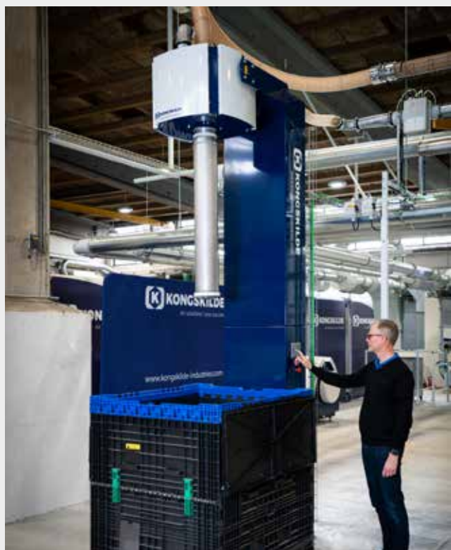
Los productos terminados se transportan desde la zona de almacenaje hasta la zona de producción o de empaquetado mediante la unidad CPU (Component Pick-up Unit)
