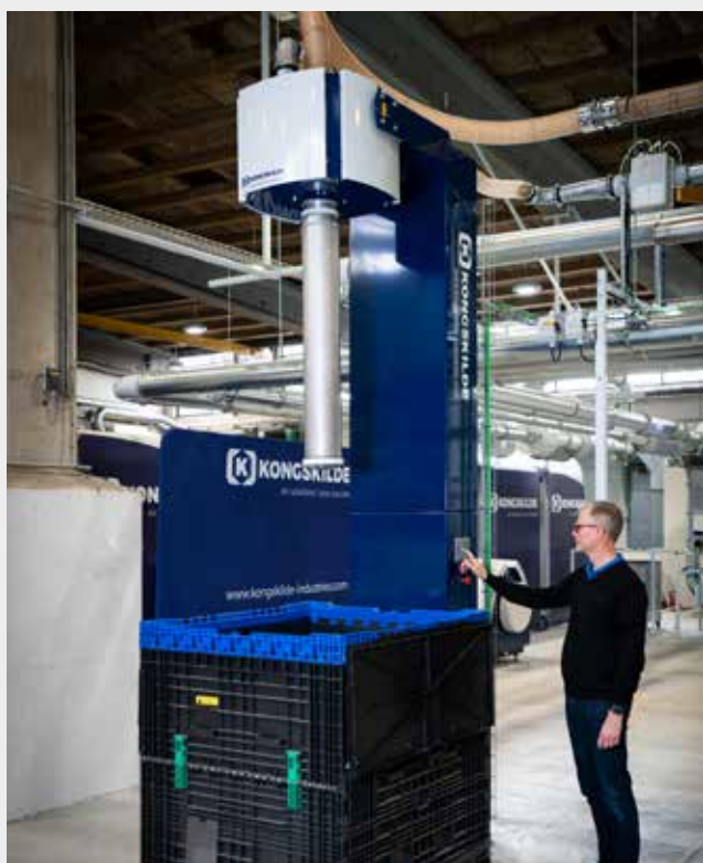
Die Aufnahmeeinheit für Komponenten fördert Fertigteile direkt vom Lager- in den Produktions- oder Verpackungsbereich.
