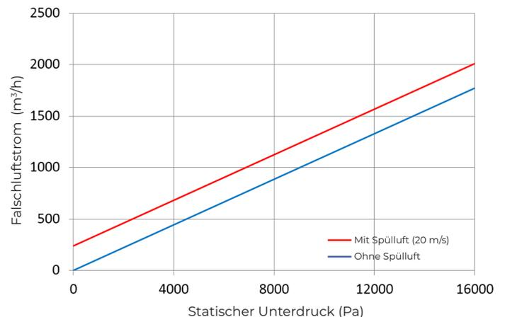
Spülluft wird zur Belüftung des Lagerbereiches verwendet, wenn Kunststoffmaterial gefördert wird. Die rote Kurve (mit Spülluft) gilt dann für die Abluft bei der Verarbeitung von Kunststoffmaterial. Die blaue Kurve gilt nur, wenn Papier und Karton gefördert werden. Die Abluft muss dem Luftstrom des Separatoreintrittes hinzugefügt werden.
