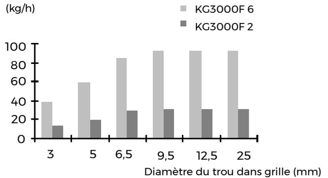
La capacité dépend du type de produit et du débit dans le granulateur. Les films étirables réduisent la capacité d'environ 1/3 par rapport à ce qui est indiqué ci-dessus.
