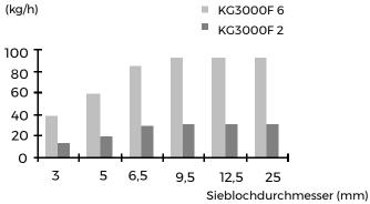
Die Kapazität ist abhängig vom Material und vom Luftstrom durch den Granulator. Stretch-Folie reduziert die Kapazität auf ca. 1/3 der o.g. Werte.
