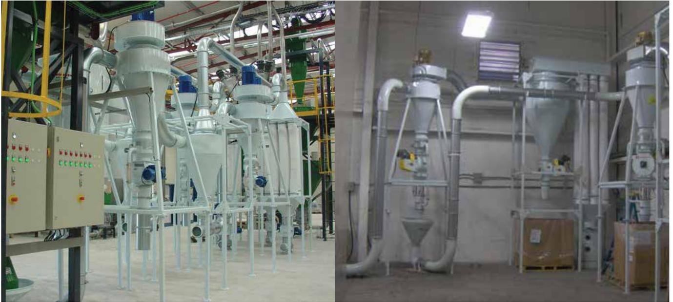
Auf dem heutigen Markt ist Kongskildes patentgeschützter Air Wash das einzige Kunststoff- Entstaubungs-System, das gleichzeitig fördern und reinigen kann. Mit seinem 2-stufigen Reinigungsverfahren ist der AirWash ein präzises Mittel zur Entstaubung, das zudem Pelletisierung unterbinden und Verarbeitungskosten drastisch senken kann.
