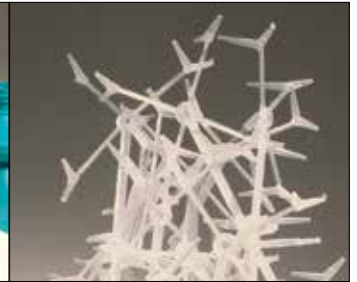
Formteilingüsse (Tops und Tails) zur Wiederverwertung.
