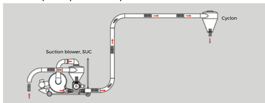
Este sistema resulta adecuado para aplicaciones que requieran una aspiración en varios puntos y descarga del producto en varios punto, utilizando una combinación de sistema por aspiración y de sistema por presión. Aplicaciones típicas de este sistema son descarga de productos a granel en vagones, de silos a depósitos o tolvas de uso diario, etc.
