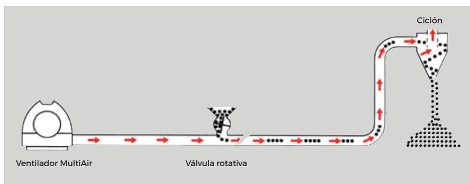
El sistema con válvula rotativa es adecuado tanto para instalaciones de alta y de baja capacidad. La válvula rotativa alimenta el producto en la línea de transporte a presión generado por el ventilador MultiAir. El ciclón separa el material del caudal de aire de transporte al final de recorrido.
