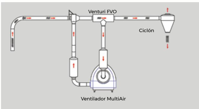
El ventilador proporciona aire a presión que al atravesar el venturi FVO, éste crea un vacío en la boca o bocas de aspiración, aspirando el producto. Una vez el producto y el caudal de aire pasan por el venturi, el sistema empuja el producto con presión de aire a lo largo de los conductos hacia el punto de descarga.
