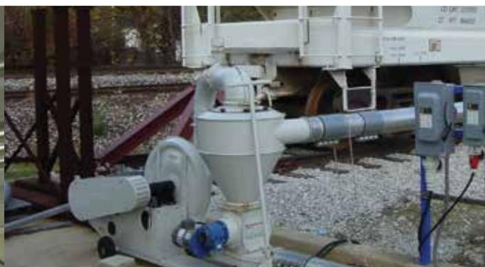
El ventilador Multiair es capaz de transportar el recorte a largas distancias y con una alta capacidad, dependiendo de las necesidades del cliente. Estos sistemas requieren de un mantenimiento relativamente bajo y pueden trabajar sin problemas durante las 24 horas del día.
