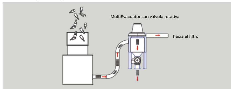
Es ideal para la aspiración de material triturado en molinos y descarga del material por gravedad mediante válvula rotativa. El caudal de aire de transporte puede conducirse a un filtro para la filtración de éste antes de su descarga al ambiente.
