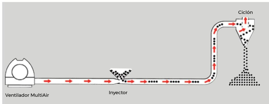
El sistema por inyector es ideal para instalaciones de baja capacidad. El inyector alimenta el producto en la línea de transporte a presión generado por el ventilador MultiAir. El ciclón separa el material del caudal de aire de transporte al final de recorrido.
