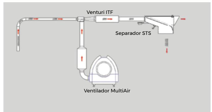
El ventilador impulsa aire a presión y cuando éste pasa a través del sistema venturi, crea un vacío en la boca o bocas de aspiración, aspirando el producto. Una vez el producto y el caudal de aire pasan por el venturi, el sistema pasa a ser por presión, empujando el producto a lo largo de los conductos hacia el punto de descarga.
