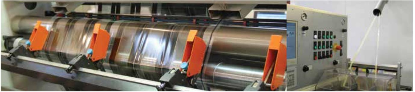
Les systèmes d'aspiration de déchets Kongskilde sont capables de traiter les lisières en provenance des machines de production de film et complexe (ligne d'extrusion) de coupeuses et bobineuses.
