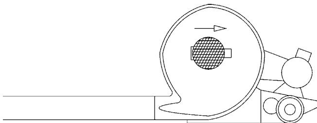
Si le moteur tourne dans le mauvais sens, on peut changer la direction en modifiant les deux phases électriques. Toutes les phases peuvent se changer, sauf la prise de terre.
