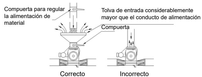
NOTA: En el caso de que se desmonte la válvula rotativa, asegúrese de que se vuelva a instalar de manera correcta. ¡La parte inferior de la válvula rotativa puede instalarse de manera errónea!
