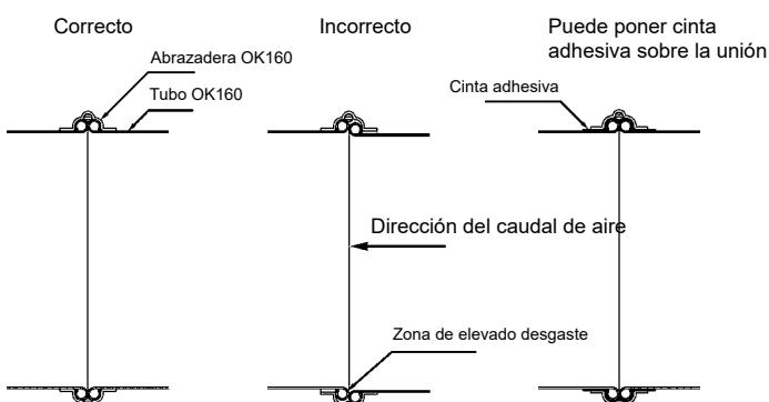
No confíe en tener alineados los conductos solo por efecto de la abrazadera de unión. La abrazadera está diseñada para presionar fuertemente entre sí los extremos de las tuberías OK con el fin de una alta estanqueidad. Esto causa que la fricción entre las tuberías sea tan alta que, la abrazadera de por sí, no sea capaz de alinear correctamente las tuberías.
