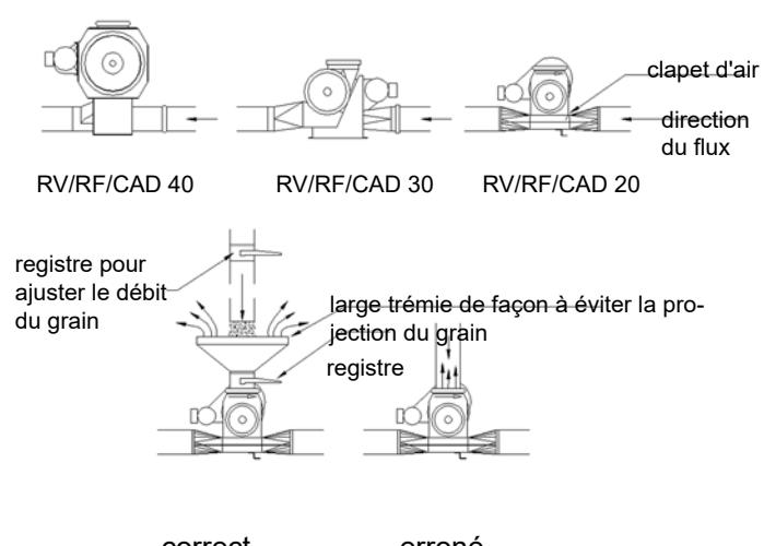
**NOTE:** Si on doit démonter l'écluse rotative, veiller à ce que celle-ci soit remontée correctement ! il peut arriver que le haut et le bas de l'écluse soient inversés.
