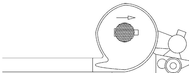
Si el motor gira en el sentido erróneo, el cambio de sentido puede hacerse intercambiando dos de las fases en el cableado del motor, sin alterar la conexión de tierra.
