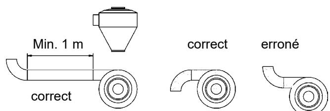
S'il faut installer un coude avant le cyclone, il doit avoir la courbure dans le même sens que le cyclone, ou alors mettre un tuyau droit de 1 m minimum entre les deux.
