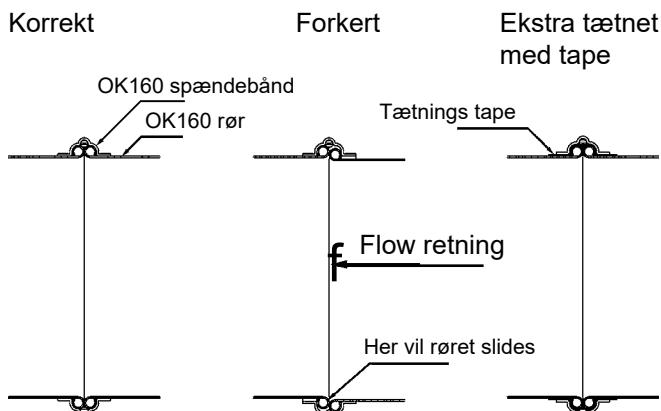
Man kan ikke blindt regne med at røret centeres af spændebåndet alene. Spændebåndet er udformet således det klemmer OK-vulsterne meget hårdt sammen, for at sikre en meget høj tæthed. Dette bevirker at friktionen mellem rørene kan blive så høj, at spændebåndet ikke kan centrere rørene.
