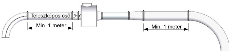
Az ITF kivezető csövét ne hosszabbítsa meg ugyanazzal a csőátmérővel, hanem növelje meg a cső átmérőjét a B. és C. táblázat szerint. Ne használjon átmenetet közvetlenül egy ív előtt.
