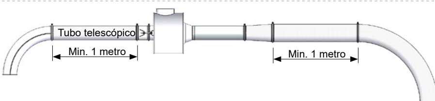
No extienda el tubo de salida del ITF con el mismo diámetro de tubo, sino aumente el diámetro de tubo de conformidad con las tablas B y C. No utilice una transición inmediatamente antes de un codo.
