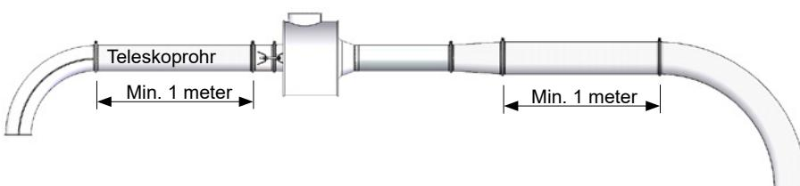
Verlängern Sie das ITF-Austrittsrohr nicht mit Rohren gleichen Durchmessers. Vergrößern Sie stattdessen den Rohrdurchmesser gemäß den Tabellen B und C. Unmittelbar vor einem Bogen darf kein Übergang montiert werden.
