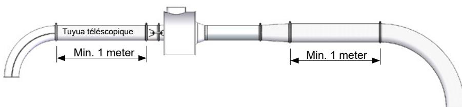
Ne prolongez pas le tuyau de sortie de l'ITF avec le même diamètre, mais augmentez le diamètre du tuyau selon les tableaux B et C. N'utilisez pas de transition juste avant un coude.
