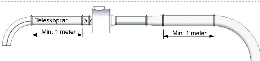
Forlæng ikke ITF'ens afgangsrør med samme rørdiameter, men forøg diameter af rør i h.t. tabel B og C.
