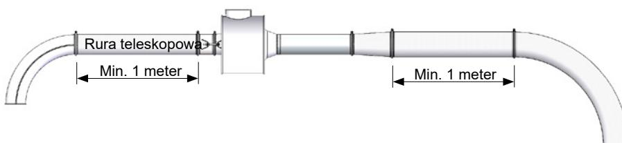
Nie przedłużać rury wylotowej ITF za pomocą rury o takiej samej średnicy, ale zwiększyć średnicę rury zgodnie z tabelami B i C. Nie używać redukcji przejściowej bezpośrednio przed łukiem.
