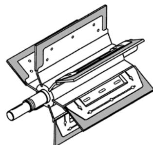
Im Zuge des Verschleißes der Dichtlippen wird mehr Luft den Rotor passieren. Diese Undichtigkeit wird es dem Material erschweren, in die Zellenradschleuse herabzufallen, wodurch die Leistung herabgesetzt wird. Wenn sie zu niedrig geworden ist, sind die Dichtlippen auszuwechseln.
