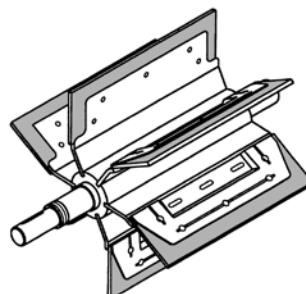
Pladernes levetid vil bl.a. afhænge af, hvilken type materiale der transportereres gennem celleslusen. Når tætningspladerne slides, vil der trænge mere luft forbi rotoren. Denne utæthed vil gøre det vanskeligt for materialet at falde ned i celleslusen og derved reducere kapaciteten. Når kapaciteten er blevet for lav, skal tætningspladerne udskiftes.
