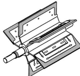
Plattornas hållbarhet är beroende av det material som transporteras genom cellslussen. När tätningsplattorna är slitna kommer mer luft att tränga förbi rotorn. Otätheten gör det svårare för materialet att falla ner i cellslussen och kapaciteten kommer därför att reduceras. När kapaciteten är för låg skall plattorna bytas ut.
