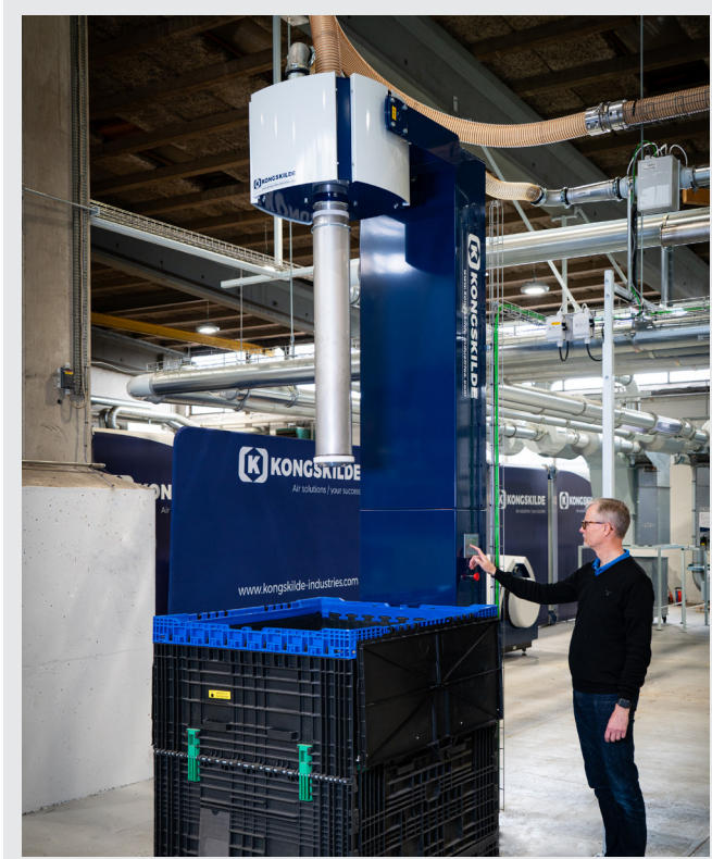
ส่วนประกอบทั้งหมดจะถูกลำเลียงจากพื้นที่จัดเก็บและไปยังพื้นที่การผลิต หรือพื้นที่บรรจุภัณฑ์โดยใช้อุปกรณ์ในการขนส่ง – CPU (Component Pick Up Unit)
