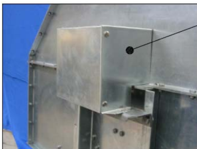
Skærm for tilbageløbsspærre, skal monteres sammen med tilbageløbsspærre når kontrol er gennemført
