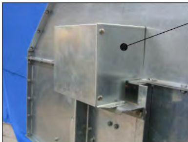
Skærm for tilbageløbsspærrer, skal monteres sammen med tilbageløbsspærrer når kontrol er gennemført
