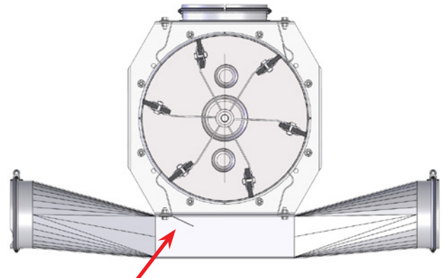
Prelplade der sikrer optimalt materialeflow
