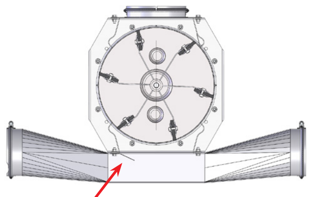
Prallplatte für optimalen Materialfluss
