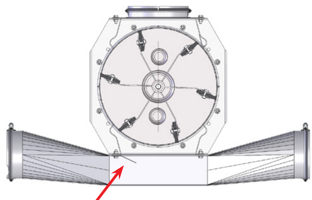
Prallplatte für optimalen Materialfluss
