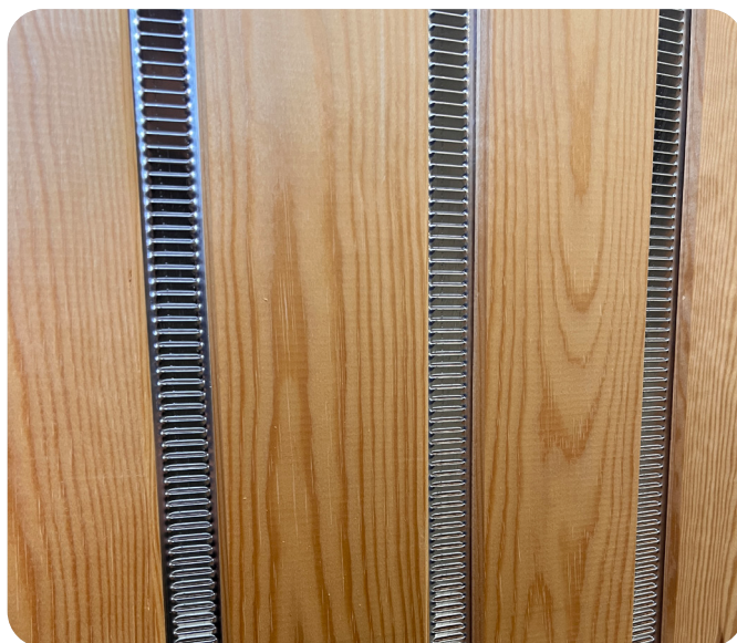
Aluminiumslamellerne sikrer en jævnt fordelt radial luftstrøm overalt i siloen. Det sikrer en skånsom og ensartet tørreproces.
