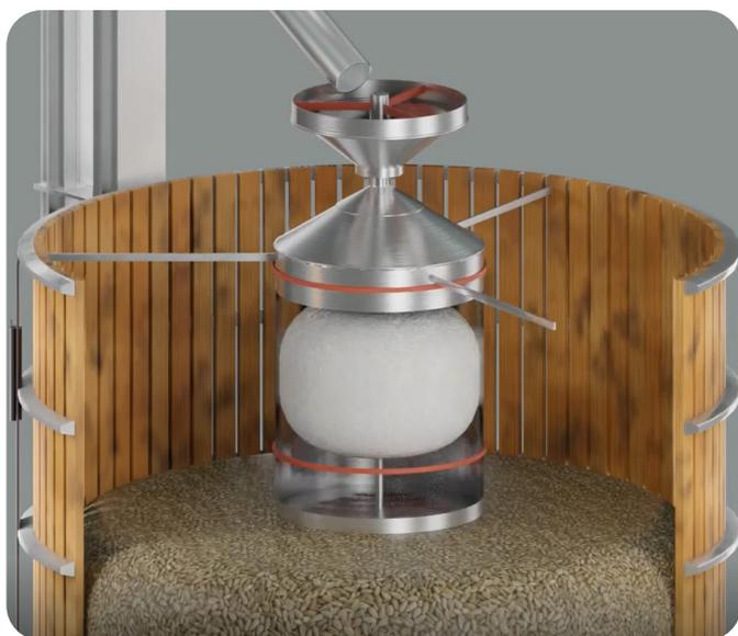
Le sac en toile est ouvert à la base, et le flux d'air ascendant presse la toile contre l'intérieur du tuyau de ventilation et empêche l'air de passer par la vanne.
