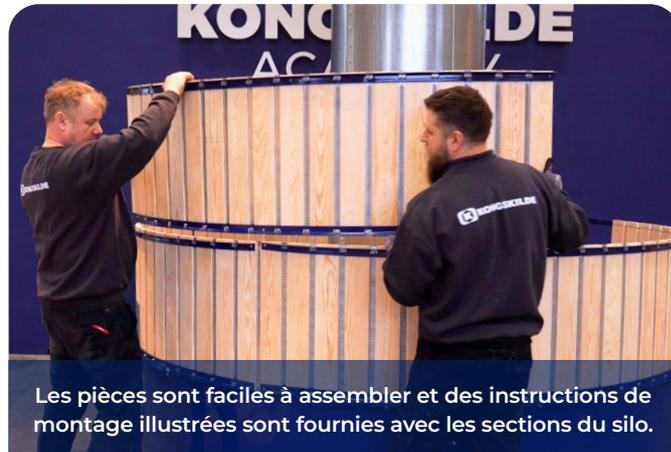
Les pièces sont faciles à assembler et des instructions de montage illustrées sont fournies avec les sections du silo.
