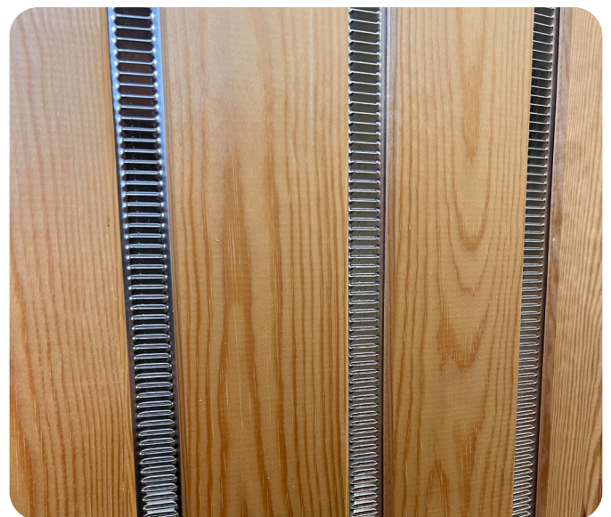
Die Aluminiumlamellen sorgen für einen gleichmäßig verteilten radialen Luftstrom überall im Silo. Dadurch wird ein schonender und gleichmäßiger Trocknungsprozess gewährleistet.
