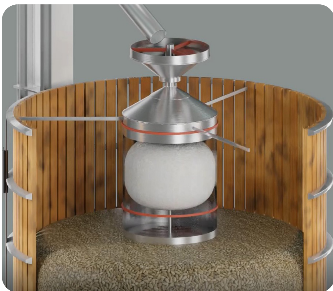
Der Leinensack ist unten offen, und der aufsteigende Luftstrom drückt die Leinwand gegen die Innenseite des Belüftungsrohrs und verhindert, dass die Luft durch das Ventil strömt.
