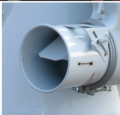
Régulateur d'air pour le réglage de la puissance d'aspiration du ventilateur aspirateur.
