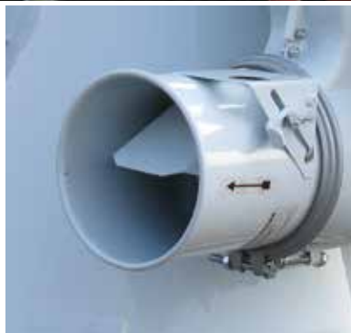
Luftregulierung zur Einstellung der Saugleistung des Absaugers.
