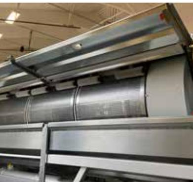
Die Seitenwände lassen sich leicht öffnen, was Zeit spart und den Siebwechsel effizienter gestaltet.
