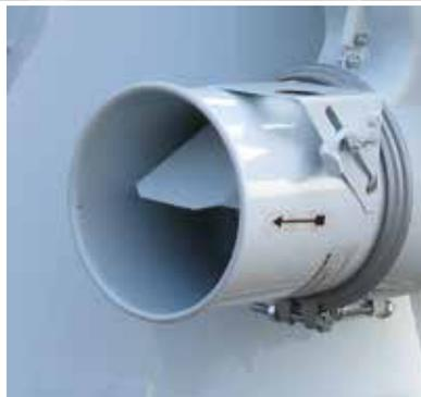
Luftregulierung zur Einstellung der Saugleistung des Absaugers.
