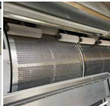
Die Reinigungsbürsten (Zubehör) sind für einen gleichmäßigen Druck auf den Außensiebe an einem federbelasteten Arm montiert.
