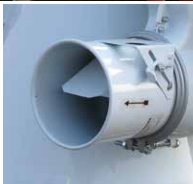
Luftregulerings-spjæld for justering af sugekraft på aspiratør
