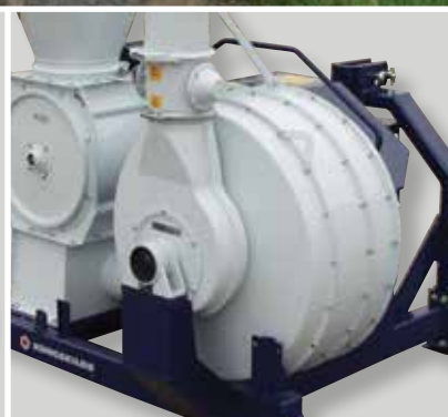
Automatická regulace vzduchu je standardní výbavou nasávacích dopravníků, poháněných vývodovým hřídelem.
