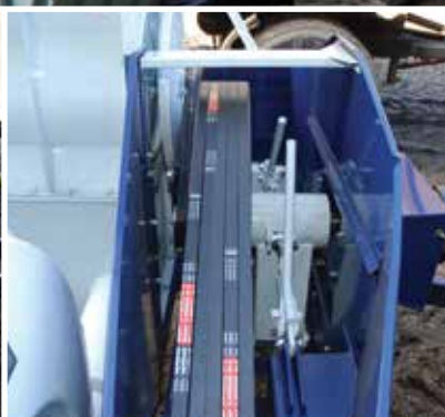
Řemeny se napínají bez nutnosti použít nářadí, to potřebujete pouze pro získání přístupu k řemenům.
