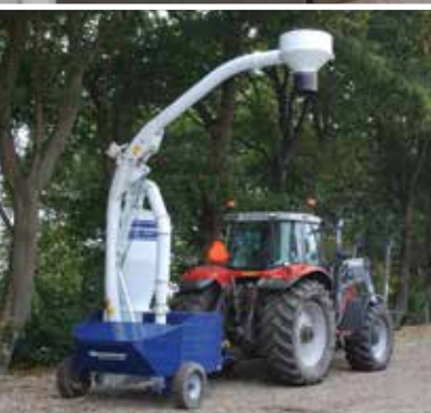
Výložník dopravníku SupraVac 2000 připravený k nakládání obilí na přívěs.
