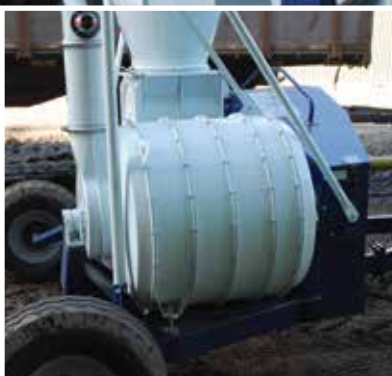
Robustní až čtyřstupňový ventilátor pro vysokou přepravní výkonnost.
