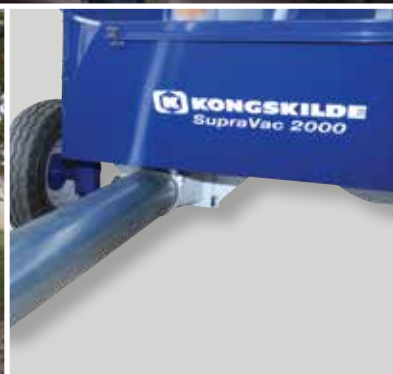
Připojení ke stacionárnímu potrubnímu systému, např. pro plnění síla.
