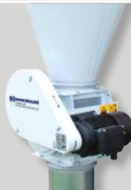
Rotační dávkovač CAE 20 namontovaný pod cyklónem v čisté sací instalaci.
