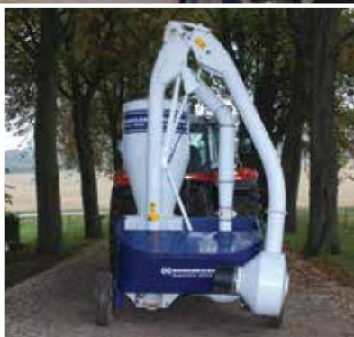
Výložník se z dopravní do pracovní polohy a zpět přestavuje hydraulicky.
