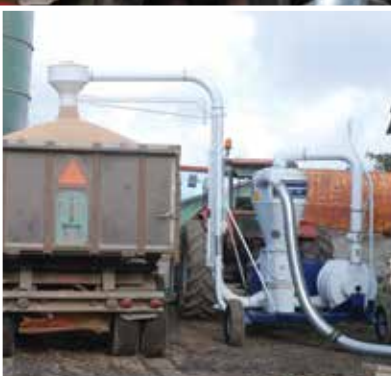
Výložník modelů TR pro snadné nakládání nákladních vozidel, přívěsů, návěsů, vagónů.
