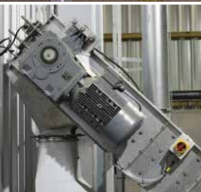
Kompaktní řešení díky kuželové převodovce.
