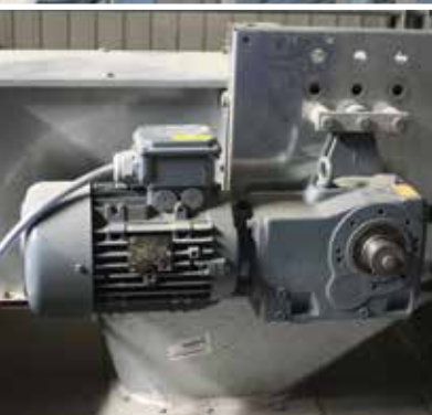
Motor s kuželovou převodovkou s vysokou účinností.
