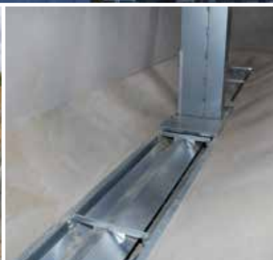
Řetězový elevátor s bočními šneky na obou stranách v příjmovém koši.
