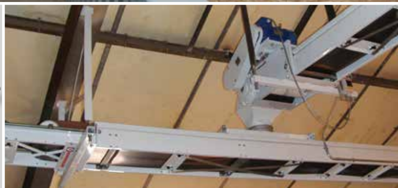
Řešení s dvěma pásy svírajícími úhel 90°. Spodní pás se může pohybovat v podélném směru.
