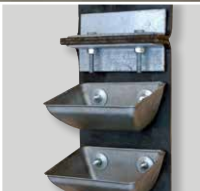
Spojení pásu a upevnění koreček pomocí přírubových šroubů.
