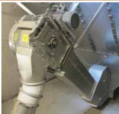
Řetězový elevátor s úhlem 45°, pohonnou sekcí s klínovými řemeny
