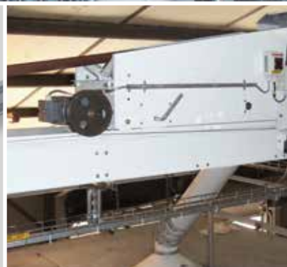
Shazovací vozík s motorovým pohonem pro BCB 45.
