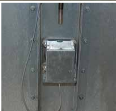
Hlídač otáček signalizuje zastavení pásu s korečky (za příplatek).
