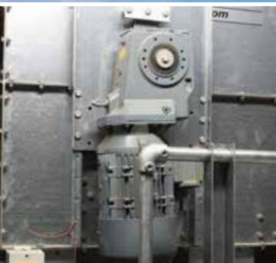
Kompaktní pohon kuželovou převodovkou.
