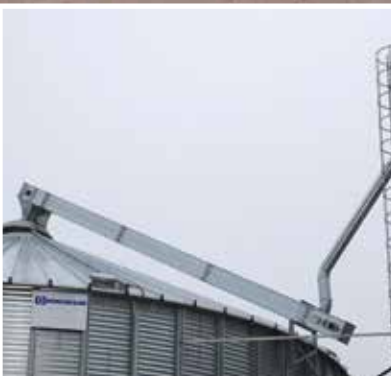
Řetězový dopravník pro šikmou dopravu po střeše sila.
