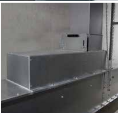
Mezivpád s regulací množství vstupujícího materiálu.
