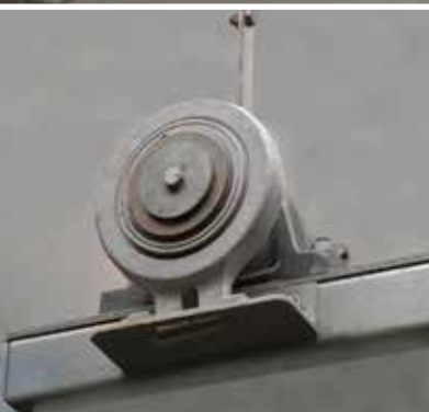
Zpětná zarážka zabraňuje zpětnému pohybu pásu elevátoru (za příplatek).
