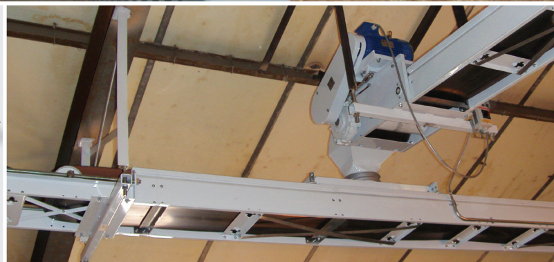
Solution intégrant deux bandes transporteuses à 90°, avec un convoyeur inférieur déplaçable dans le sens longitudinal.
