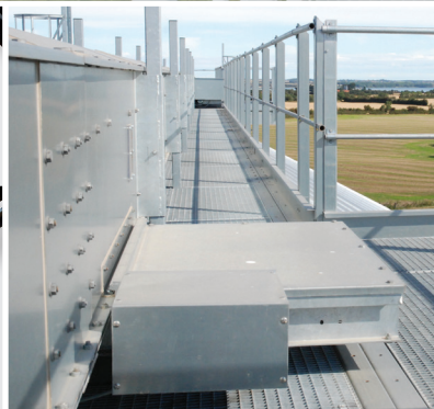
Sortie intermédiaire montée dans la base du convoyeur, disponible en version manuelle ou motorisée.
