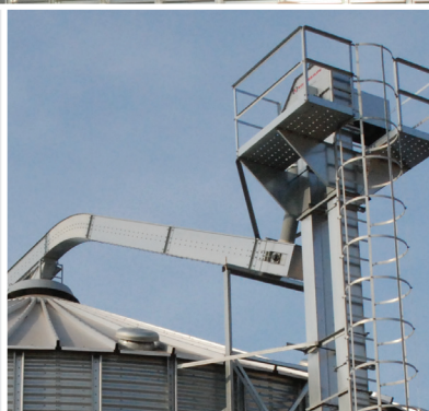
Conveyeur à chaîne KCA avec angle passant de la position inclinée à l'horizontale.
