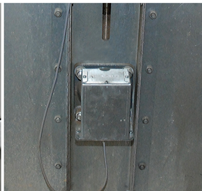
Le contrôleur de rotation détecte et signale l'arrêt de la sangle à godets (en option).
