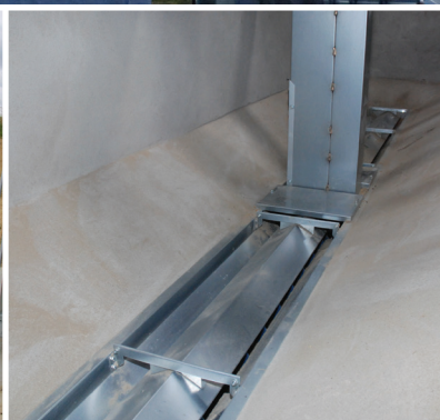
Vis en auge pour fosse, chargement des 2 côtés de l'élévateur.
