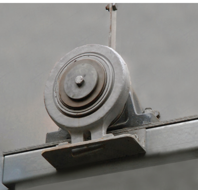
L'anti-retour évite le retour en arrière de la sangle à godets (option).
