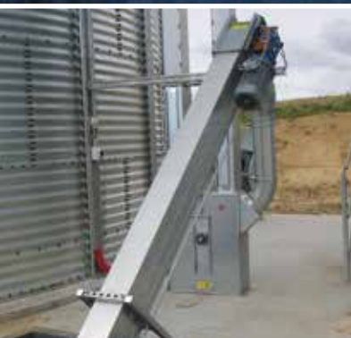
Kædeelevator til fyldning af siloer.
