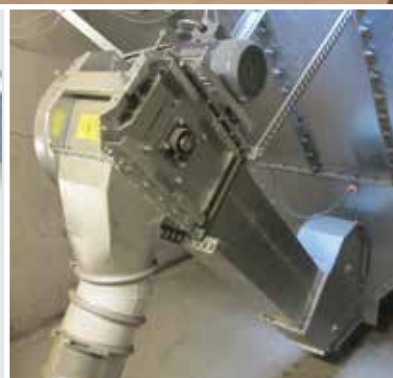
Kædeelevator med 45 gr. vinkel. Drevsektion med remtræk.
