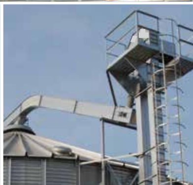
KCA kædetransportør med vinkelsektion fra stigende til vandret transport.
