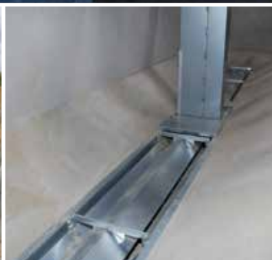
Kædeelevator med sidesnegl til begge sider i korngrav.
