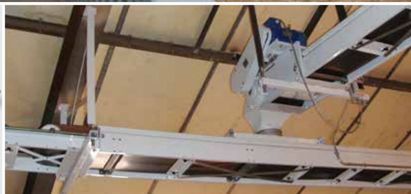
Løsning med to bånd monteret i 90° vinkel. Nederste transportbånd kan flytte i længdretningen.
