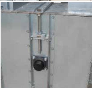
Stramning af kopremmen gøres ved at justere remhjulet i elevatorfoden.
