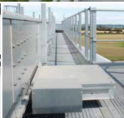
Mellemudløb monteres i transportørens bund. Betjenes manuelt eller elektrisk.
