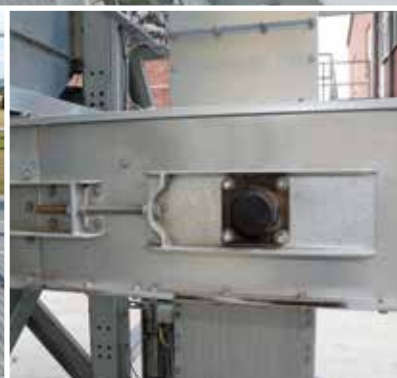
Vendesektion med anordning til opspænding af transportkæde.
