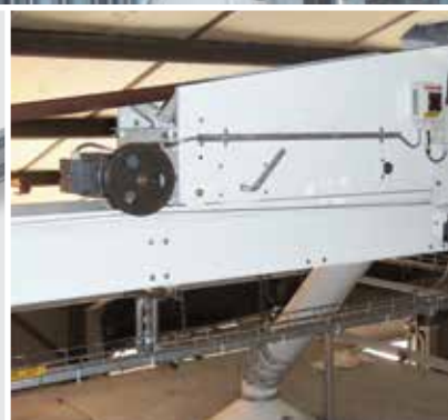
Afkastervogn med motortræk til BCB 45.
