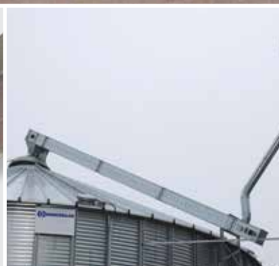
KCA kædetransportør til stigende transport langs med silotag.
