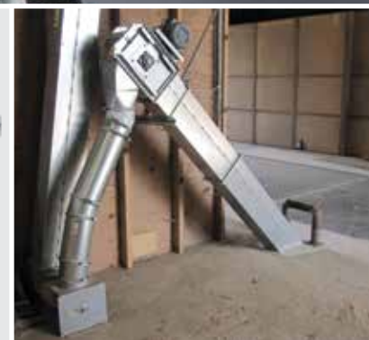
Kædelevator fra korngrav afleverer kornet i flexfod på næste elevator.
