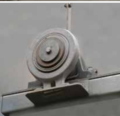
Tilbageløbsspærre forhindrer tilbageløb af elevatorrem (ekstraustyr).
