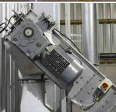
Keglehjulsgeare giver kompakt løsning.
