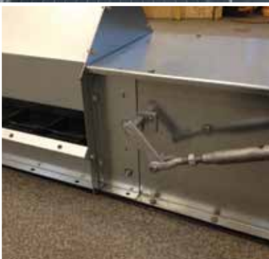
Forlænger med sideindløb og kapacitetsregulering.
