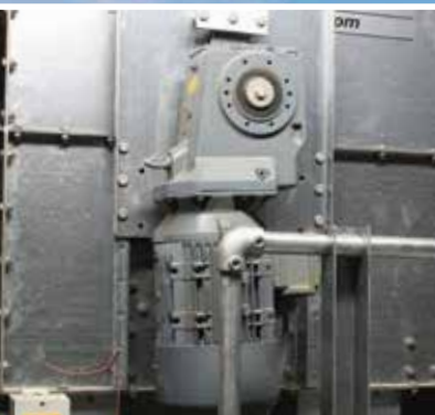
Kompakt drevløsning med keglehjulsgear.
