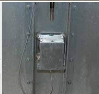
Hastighedsvagt giver signal ved kopperemsstop (ekstraustyr).
