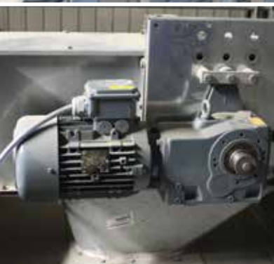
Keglehjulsgearmotor med høj virkningsgrad.
