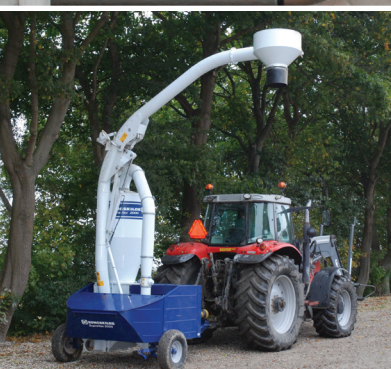
Mât de chargement hydraulique pour chargement direct camion.
