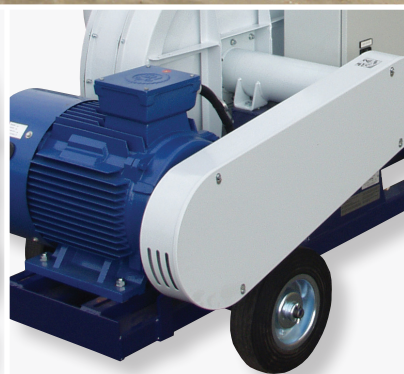
Transmission par courroie des moteurs ventilateur et écluse.
