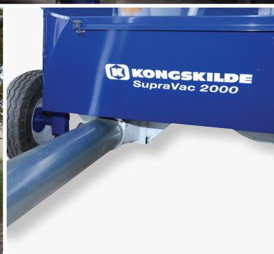
Connexion tuyauterie spéciale pour chargement silo, stockage à plat etc.
