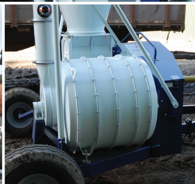
Ventilateur haute pression avec 4 rotors offrant une excellente capacité de convoyage.
