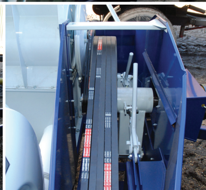
Réglage des courroies sans outillage particulier à l'exception de l'accès au compartiment tension.
