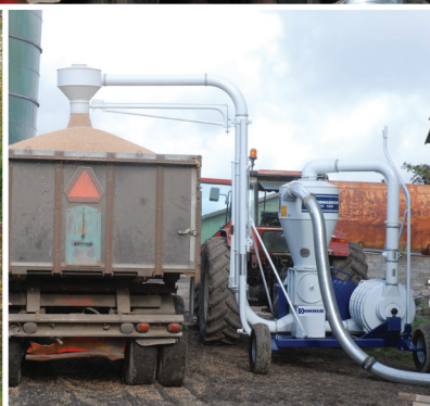
Les modèles TR avec mât de chargement conviennent parfaitement pour le chargement direct camion ou remorque.
