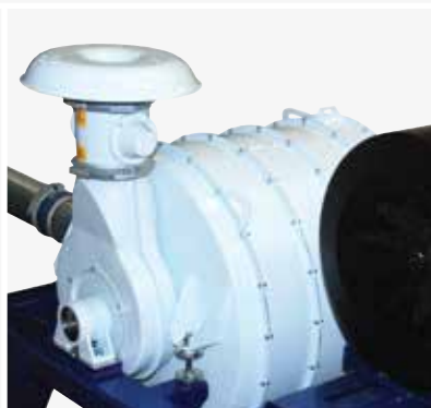
Automatische Luftregulierung am TRL 1000. Der Schieber schließt sich beim Starten automatisch.
