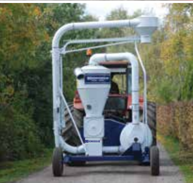
Gebläse mit Verladeausrüstung in Position für Straßenverkehr.
