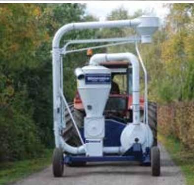
Gebläse mit Verladeausrüstung in Position für Straßenverkehr.
