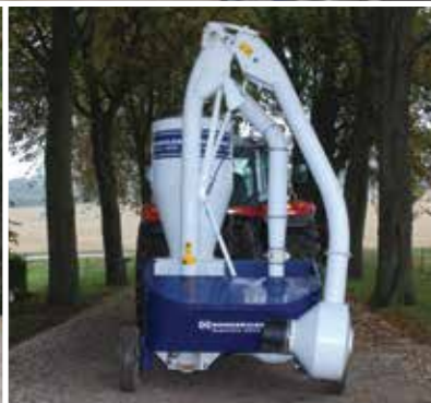
Hydraulisch in die Förderposition gefahrene Verladeausrüstung.
