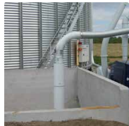
Langer Saugkopf: Besonders für die Förderung aus der Getreidegasse geeignet.
