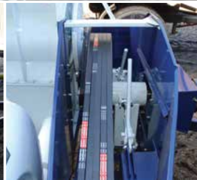
Riemen spannen ohne Werkzeug, nur für den Zugang zu den Riemen wird Werkzeug benötigt.
